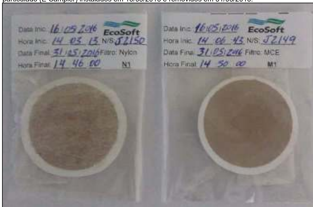
Fotografia 5.1 - Filtros de amostragem Nylon (N1) e MCE (M1) dos analisadores de material particulado (E-Sampler) instalados em 16/05/2016 e removidos em 31/05/2016.
