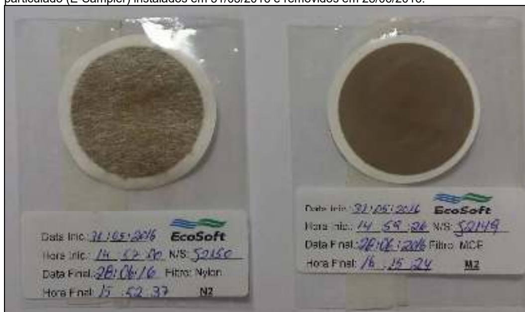
Fotografia 5.1 - Filtros de amostragem Nylon (N2) e MCE (M2) dos analisadores de material particulado (E-Sampler) instalados em 31/05/2016 e removidos em 28/06/2016.
