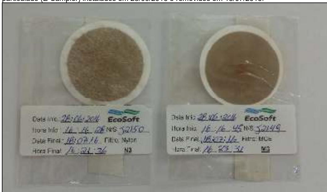
Fotografia 5.1 - Filtros de amostragem Nylon (N3) e MCE (M3) dos analisadores de material particulado (E-Sampler) instalados em 28/06/2016 e removidos em 18/07/2016.
