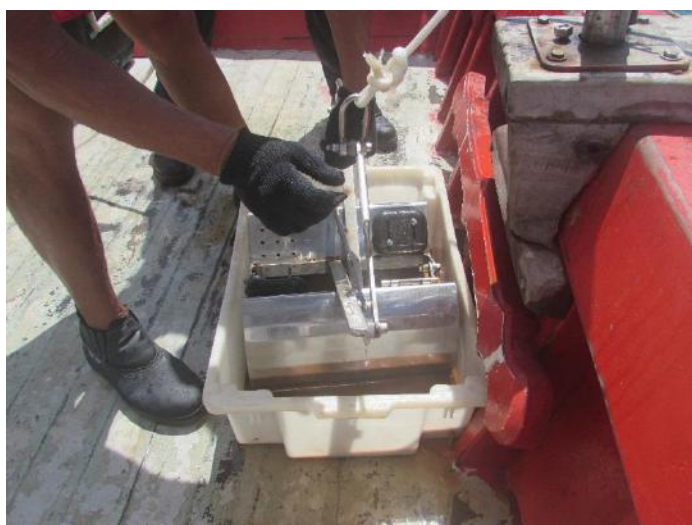
Figura A-2: Amostrador Van Veen utilizado para coleta de sedimentos do fundo marinho (Foto: Econservation).
